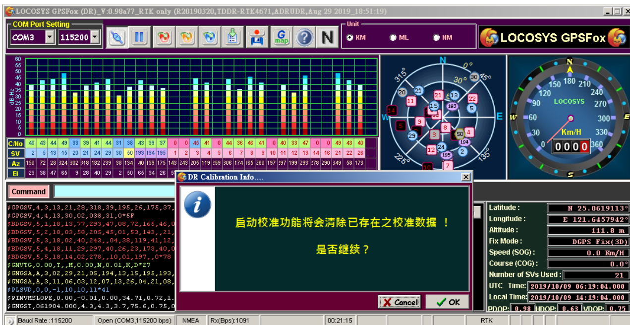
图 20: RTK-4671-SHDR 进行微机电系统校准，点选 OK 开始系统校准。
